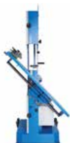
BANCO INCLINABILE PER RIDURRE L'INGOMBRO INCLINING TABLE TO REDUCE BULK
